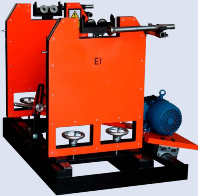
**La Balanceadora EI-1000** es ideal para todo tipo de piezas giratorias de hasta 1000 kg de peso, tales como rodillos, rotores de motor, cigüeñales, molinos, entre otros. Las bases flotantes de la **EI-1000** se fabrican resistentes y ligeras para reducir la inercia mecánica.
