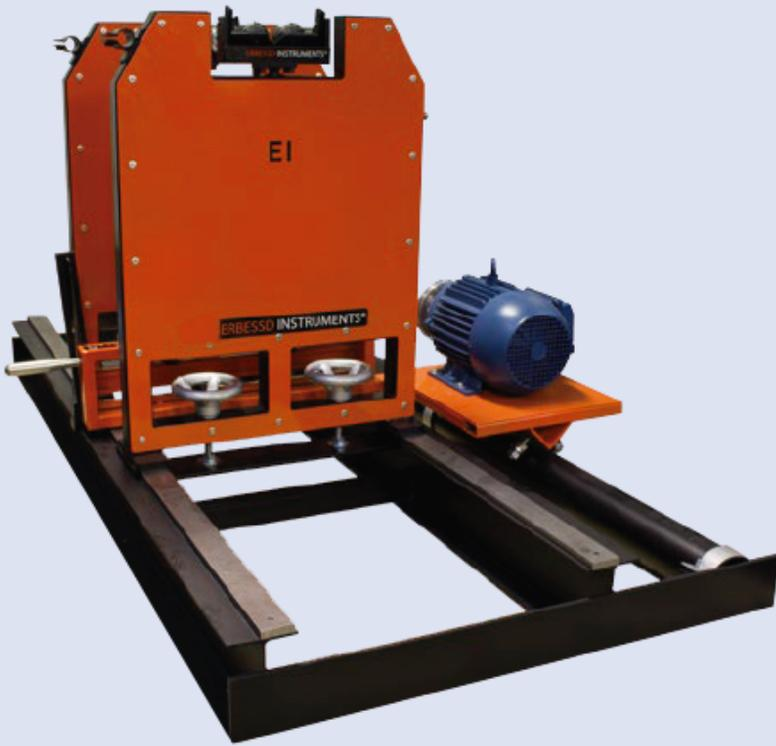
**La Máquina de Balanceo EI-2000** es ideal para todo tipo de piezas giratorias de hasta 2000 kg como rodillos, rotores de motor, cigüeñales, molinos, entre otros. Las bases flotantes de la **EI-2000** se fabrican resistentes y ligeras para reducir la inercia mecánica
