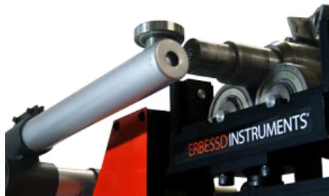
⋮ Diseñado para limitar el desplazamiento axial del rotor en la **Máquina de Balanceo EI-2000**. Tiene 2 ejes para ajustar la longitud de la flecha hasta 1 metro desde los soportes. Incluyen la base de montaje para el pedestal de balanceo, un brazo axial y radial, y un elemento rodante en la punta.
