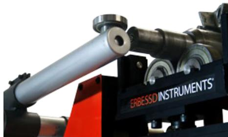
Disegnado para limitar el desplazamiento axial del rotor en la **Máquina de Balanceo EI-3000**. Tiene 2 ejes para ajustar la longitud de la flecha hasta 60 cm desde los pedestales. Incluyen la base de montaje para el pedestal de balanceo, un brazo axial y radial, y un elemento rodante en la punta.
