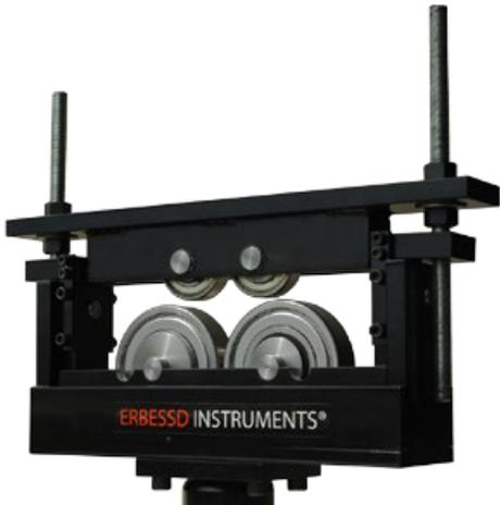
Es un accesorio requerido cuando los rotors por balancear están montados en voladizo y / o para asegurar rotors con altos niveles de vibración, como los cigüeñales.
