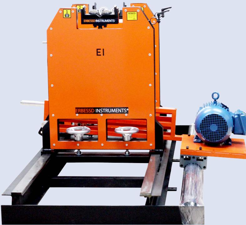
**La Máquina de Balanceo EI-300** es ideal para todo tipo de piezas giratorias de hasta 300 kg, como rodillos, rotores de motor, cigüeñales, ventiladores, molinos, entre otros. Las bases flotantes de la **EI-300** se fabrican resistentes y ligeras para reducir la inercia mecánica.
