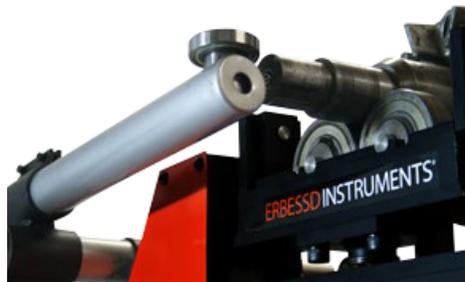
Diseñado para limitar el desplazamiento axial del rotor en la **Máquina de Balanceo EI-300**. Tiene 2 ejes para ajustar la longitud de la flecha hasta 1 metro desde los soportes. Incluyen la base de montaje para el pedestal de balanceo, un brazo axial y radial, y un elemento rodante en la punta. **EI-300 incluye 2 soportes.**
