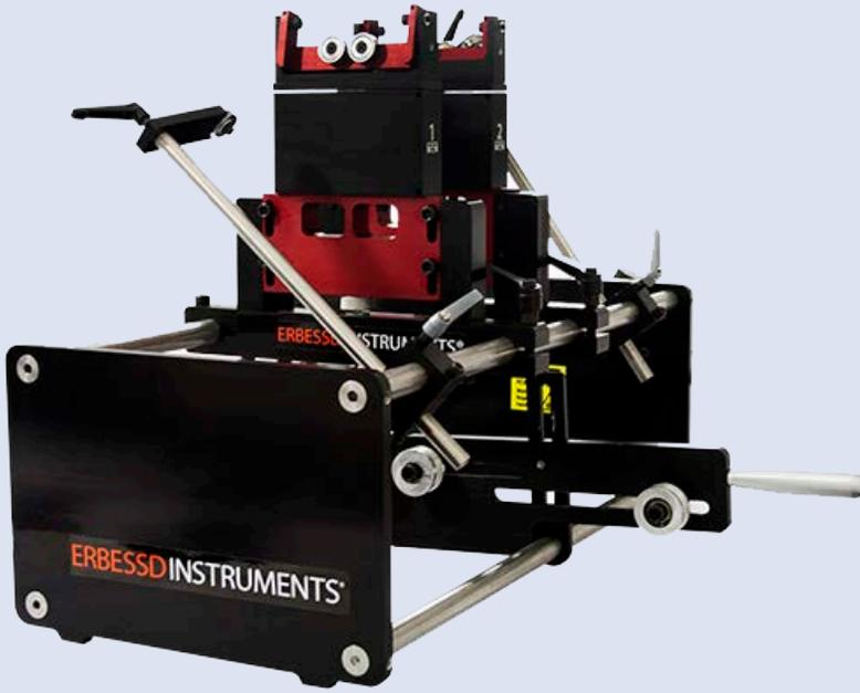
**EI-30 es una balancadora horizontal de alta precisión** ideal para turbocompresores de alta velocidad, así como para todo tipo de rotores de bajo peso. La baja inercia reduce la resistencia a la vibración y **aumenta la sensibilidad y precisión** del proceso de balanceo.
