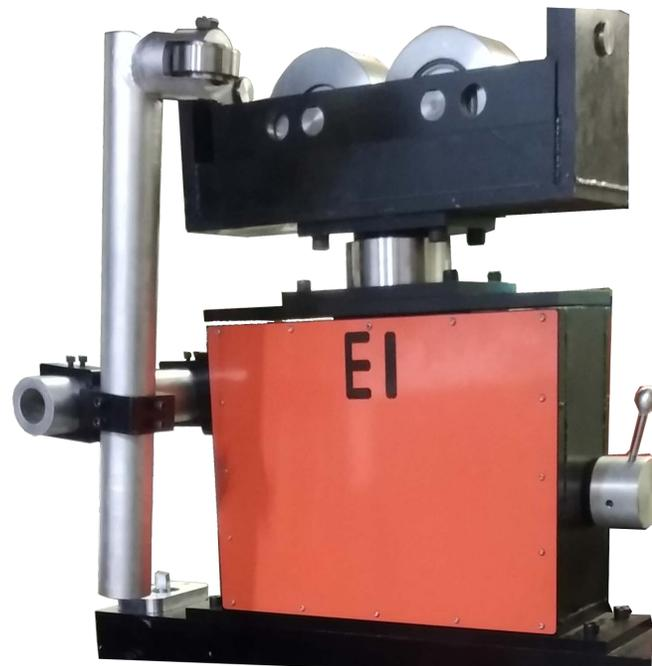
La rotación de la pieza se efectúa usando un motor de corriente alterna y un sistema de transmisión por banda plana tensionado manualmente con una polea de ajuste. Los Acelerómetros incluidos en el maletín digivibe se instalan de forma sencilla para un funcionamiento óptimo.
