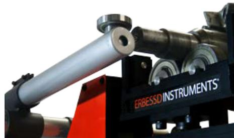
Diseñados para limitar el desplazamiento axial del rotor. Incluye dos brazos para ajustarse a flechas de hasta 1 metro de longitud desde los soportes.
