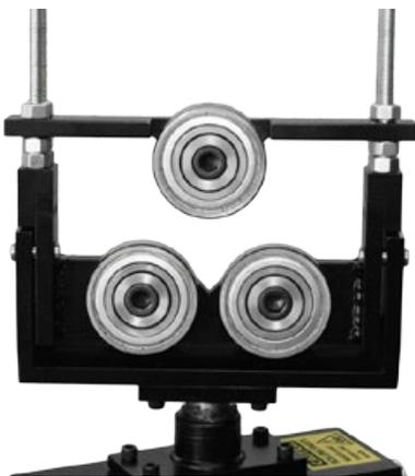
Es un accesorio para la Máquina de Balanceo EI-500 requerido cuando los rotores están montados en voladizo y/o para asegurar rotores con altos niveles de vibración, como cigüeñales.
