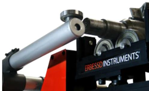
Diseñado para limitar el desplazamiento axial del rotor en la Máquina de Balanceo. Tiene 2 ejes para ajustarse a la longitud de la flecha. Incluyen la base de montaje para el pedestal, un brazo axial y radial, y un elemento rodante en la punta. **EI-500 incluye 2 soportes.**
