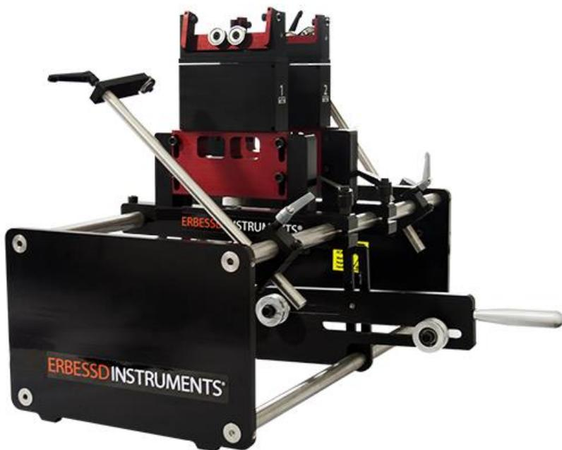
EI-30 es la balanceadora horizontal de **Alta Precisión** ideal para ensambles de turbocompresores de alta velocidad y todo tipo de rotores de bajo peso. La baja inercia de sus componentes mecánicos reduce la resistencia a la vibración y aumenta la sensibilidad y precisión del proceso de balanceo.
